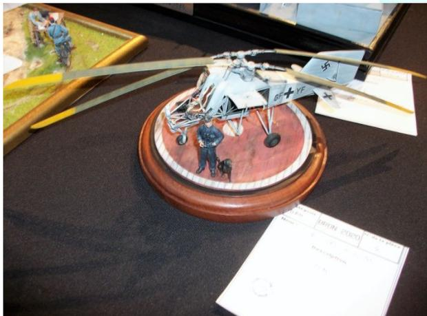
Hélicoptère léger K1 282 Kolibri à rotors engrenants utilisé en observation dans la marine allemande en 1943. En cas de panne moteur, le passage en mode gyroplane était automatique
