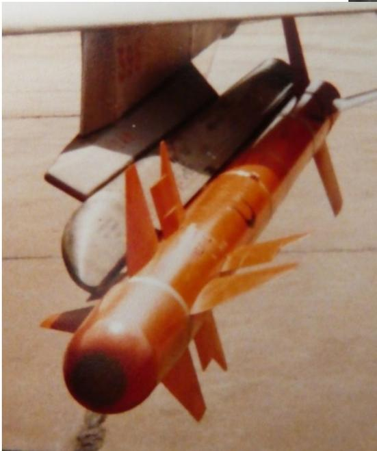
**Missile « Magic »** : Le Matra R 550 est un missile air-air à guidage infra-rouge dont la portée peut atteindre 15 km Il équipera les Crusader, Super Etendard et Mirage à partir de 1975 avant d'être remplacé par le Magic II plus puissant et à meilleur autodirecteur
