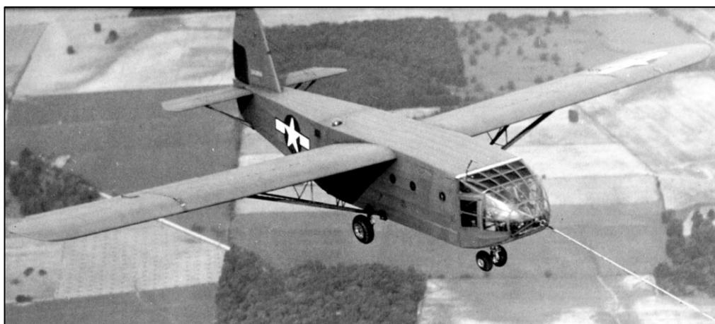
Le CG 13A pouvait transporter 40 hommes équipés ou 4650 kg. de matériels (canons, véhicules etc.) - Vitesse de remorquage 220 km/h.
