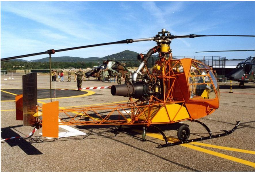
**DJINN turbo de la SNCASO ou plus précisément à rotor entraîné par un prélèvement d'air en sortie du compresseur de la turbine dont on voit le collecteur. Le souffle résiduel du réacteur affranchit du rotor anti-couple.**
