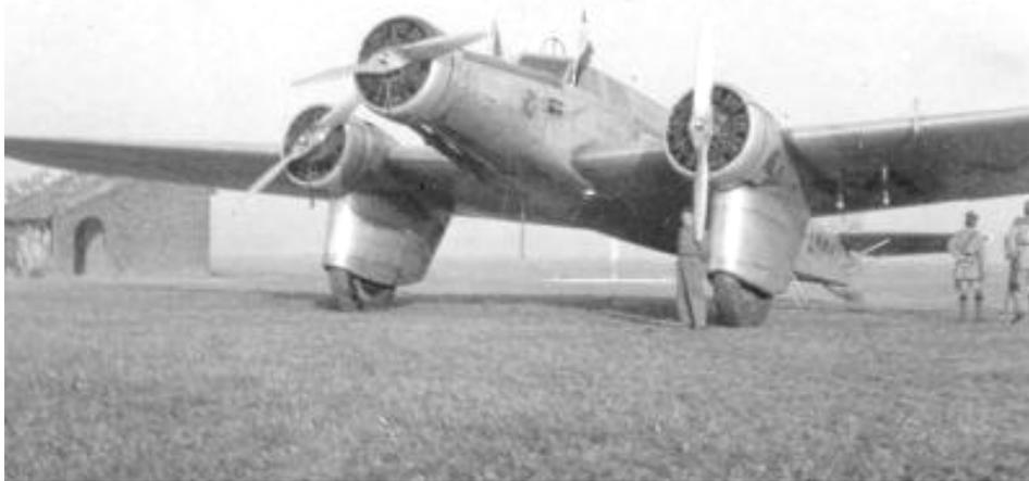
*L'appareil sort d'usine en mai 1933 : c'est un trimoteur entièrement métallique à train fixe avec des Hispano-Suiza 9 cylindres en étoile, de 575 ch chacun, à hélice fixe bipale. Son autonomie est de 2 000 km à 250 km/h en croisière et un plafond de 6 500 m. Pour 8 passagers et 2 hommes d'équipage*
