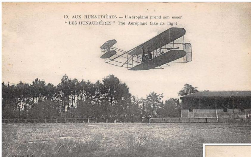
Avec le Flyer III, et un moteur Barriquand et Marre 4 cyl. de 25 ch, le double de puissance que leur propre moteur d'origine, entraîne par chaînes, deux hélices inversées, par l'arrière.
